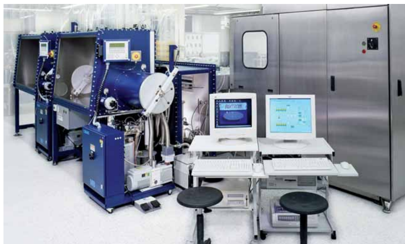
AIXTRON OVPD Pilot Production Cluster: Produktionsanlage der Aixtron AG für OVPD Beschichtungsverfahren, Projektpartner des Helmholtz-Zentrums Berlin
